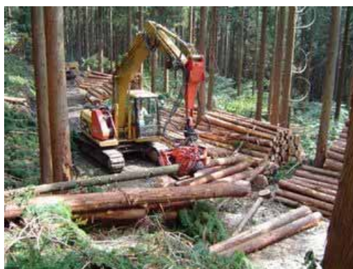
枝払いと玉切りを行う高性能林業機械（プロセッサ）
