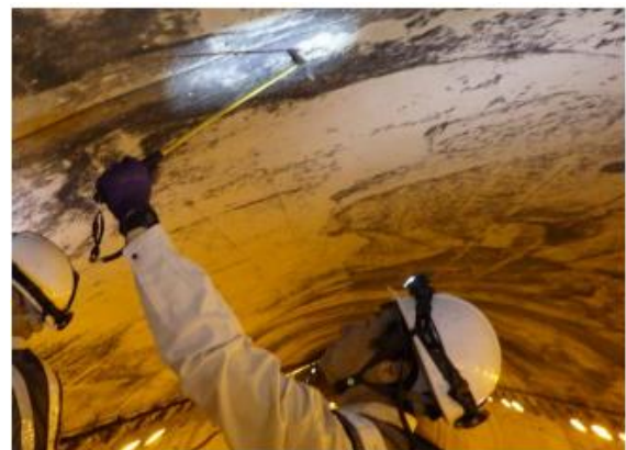
図 4 打音検査範囲および点検状況
