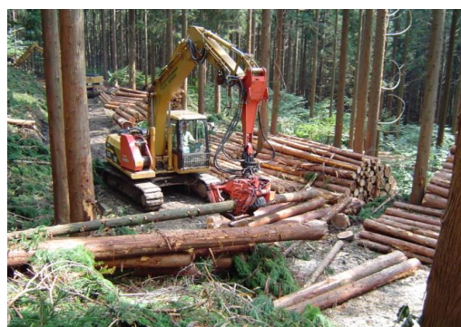
枝払いと玉切りを行う高性能林業機械（プロセッサ）
