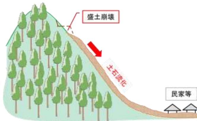
図6-1-4 盛土崩壊による土石流の発生
