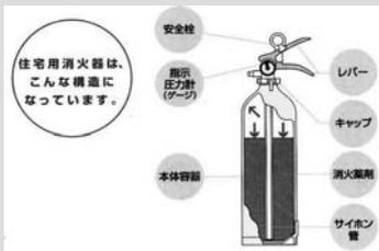
この消火器は本体にあらかじめガスを蓄圧している消火器で、レバー操作によりバルブを開き消火剤を放出する仕組みになっています。万が一、本体が老朽化などで腐食し穴が空いてしまっても、そこからガスが抜けるため
