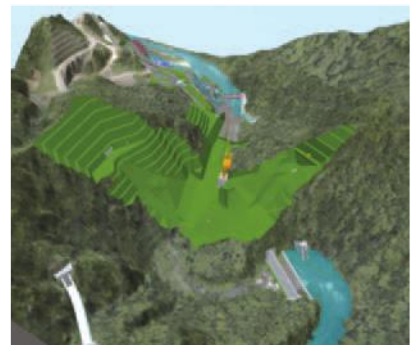
③基礎掘削
