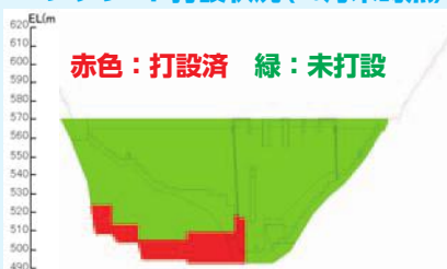
コンクリート打設状況(10月末時点)
