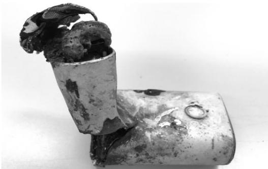
▲破砕機の圧縮により爆発した加熱式たばこ
