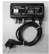
ONU電源供給器
