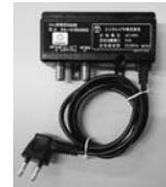
ONU 電源供給器
