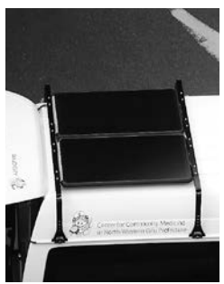
屋根にソーラーパネルを設置しています
