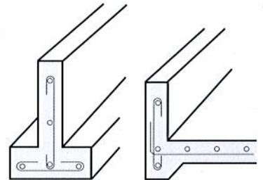
鉄筋コンクリート布基礎の代表例
