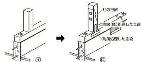
**土台・柱・筋かいなどの接合は金物等を使って堅固にします。**
