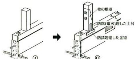
**土台・柱・筋かいなどの接合は金物等を使って堅固にします。**
